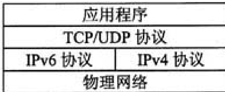
图1 IPv4/v6双协议栈的协议结构
